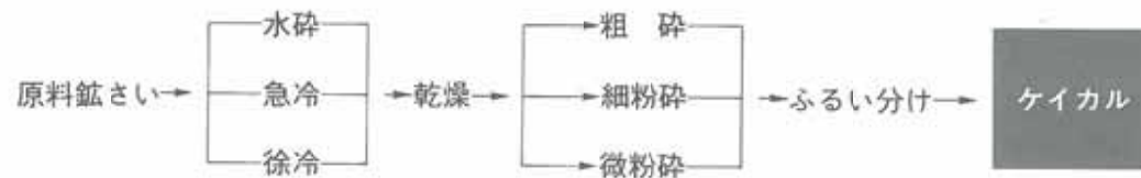
第2図 ケイカルの製造工程図
